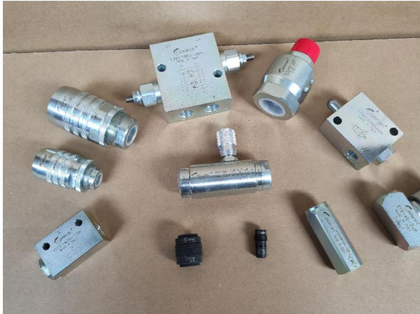
液压阀在运行时属于工业中常用的一种通过压力控制的自动化元件，其设备在进行工作的过程中其主要的受内部的压力油控制，在进行使用时可通过与配压阀的配合来进行比较远距离的水电管路控制。液压阀块上安装阀、法兰的表面粗糙度应达到 $Ra0.4$ ，末端管接头的密封面的表面粗糙度应达到 $Ra3.2$ 。另外，安装管接头的螺孔与其外贴合面之间的垂直度允差至少应为8级。液压阀的阀块上所有螺孔应有加工精度要求，一般情况下会选择其7h，其螺纹式插装阀的安装孔的加工精度应附合产品样本的要求，插装阀安装孔的粗糙度为 $Ra0.8$ 。此外还要有尺寸公差和形位公差要求。O型圈沟槽的表面粗糙度为 $Ra3.2$ ，一般流道的表面粗糙度为 $Ra12.5$ 。
